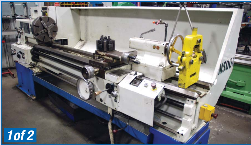
TOS SN 50C LATHE, 20" X 80"
